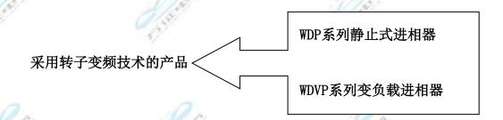
进相器采用转子变频技术的一种特殊应用,其工作原理是将单相380V交流电,通过12只晶闸管和6只平衡电抗器,变换成与电机转子频率相同(f1.s≈1Hz)的三相交流电,该电流通入转子回路,在转子回路中产生一个超前于转子近90°的附加电势Ek,进而改善电机的功率因数,随着附加电势Ek的逐步升高,定子侧的无功功率逐渐下降,功率因数逐步上升,定子电流逐渐减小。当补偿电压升高到一定值后,定子侧的无功功率减小到接近于零,功率因数上升到近似于1,从而降低定子电流,延长电机的使用寿命,达到节约能源、降低单位产品成本。
